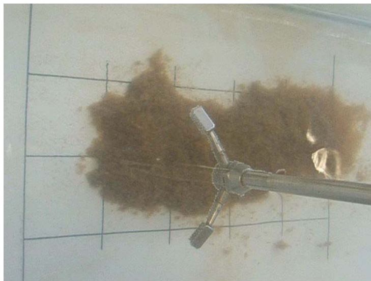
Floc mat eroding
